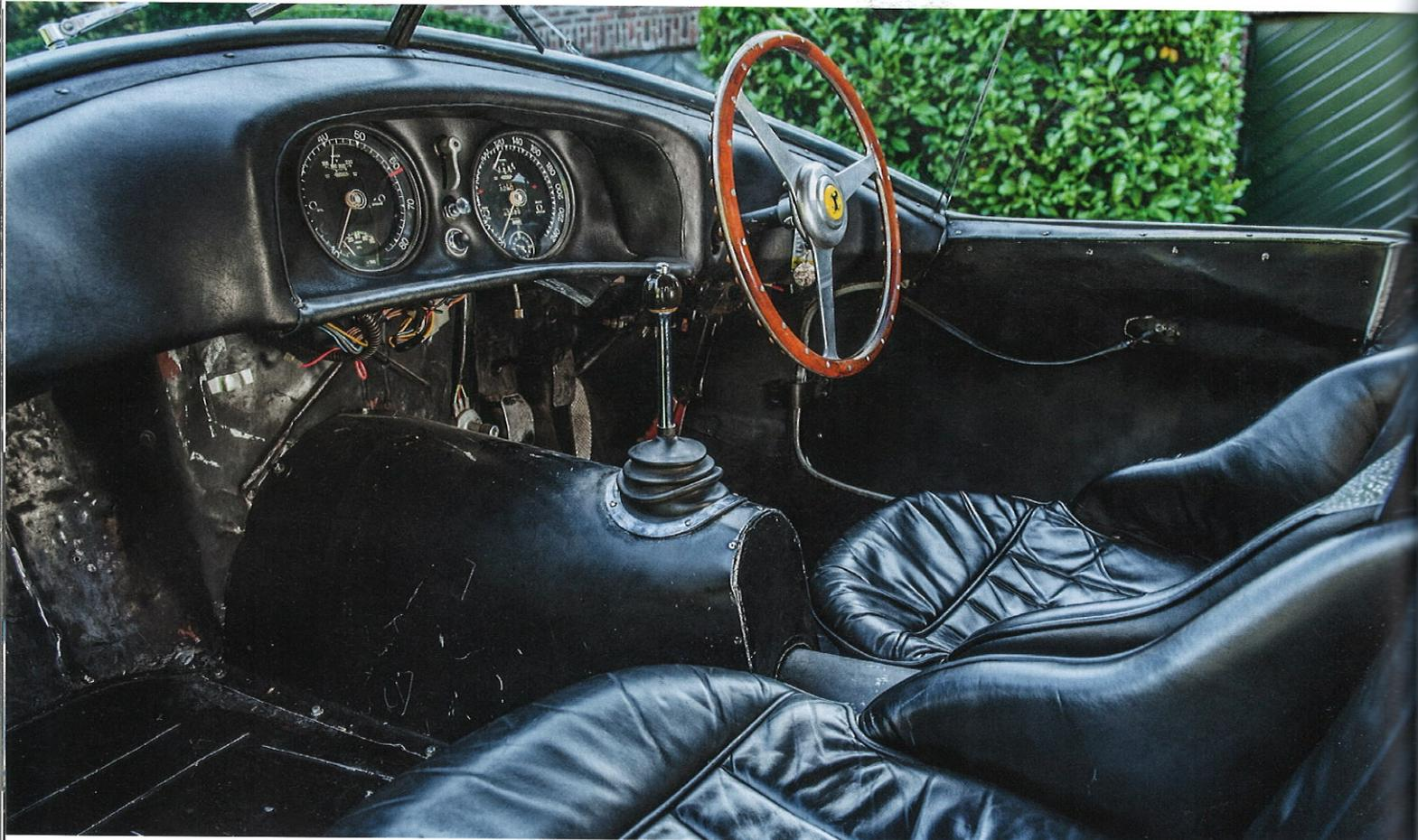
*Der handwerkliche Charakter des Einzelstücks offenbart sich in jedem Detail. Bis auf Motor, Getriebe und Chassis wurden sämtliche Komponenten in der Carrozzeria Fontana neu angefertigt. Einen Windschutzscheibenrahmen gibt es nicht – nur einen Mittelsteg und zwei straff gespannte Zugseile links und rechts, die die Dachhaut festhalten.*
