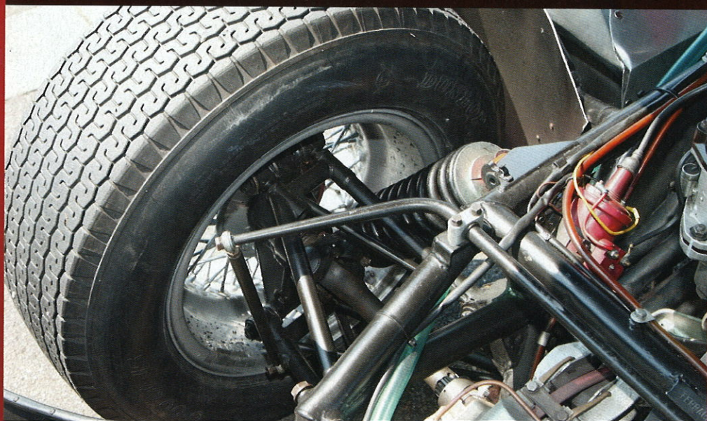
Radaufhängung hinten: Querlenker, Federbein und Stabi. Am unteren Bildrand sieht man die Scheibenbremse
